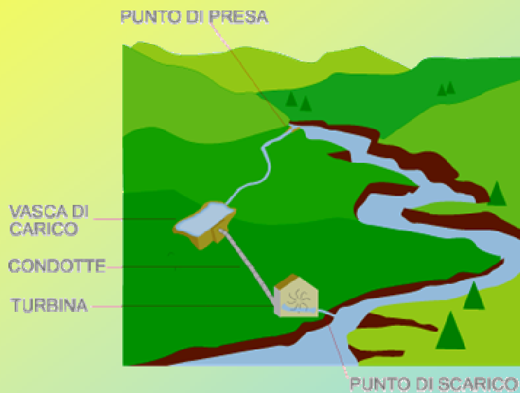
Schema di funzionamento di un impianto microelettrico ad acqua fluente
